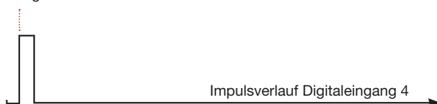
Abb.: Prinzip Impulsverlauf am Digitaleingang 4 - steigende Flanke
