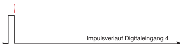
Abb.: Prinzip Impulsverlauf am Digitaleingang 4 - fallende Flanke
