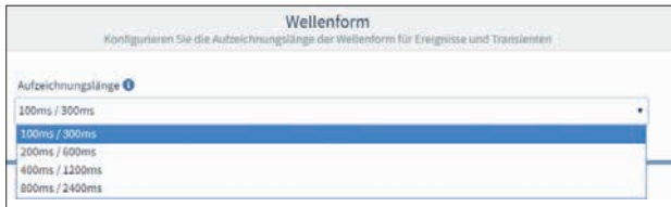
Abb. Fenster Wellenform mit der Konfiguration der Vorlaufzeit und Nachlaufzeit im Menü Aufzeichnung der Software GridVis - Konfiguration der Aufzeichnungslänge.
