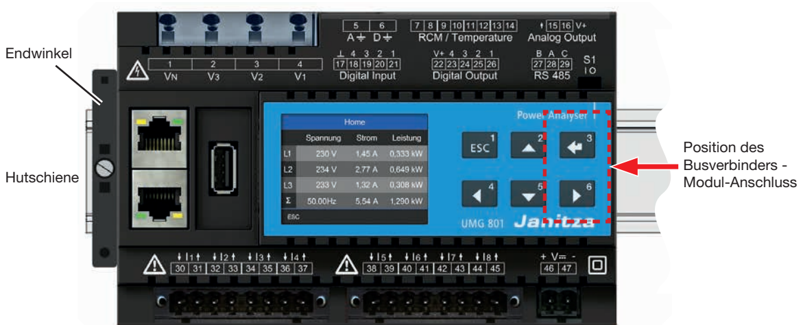
Abb. 5: Gerät mit Klemmen auf Hutschiene nach DIN EN 60715 (Frontansicht)
