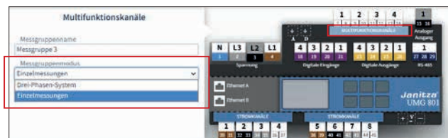
Screenshot der Konfiguration des Messgruppenmodus „Einzelmessungen“ in der Software GridVis®.
