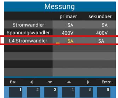
Abb. Fenster Messung mit den L4-Stromwandler-Einstellungen des RCM-Moduls (Standardeinstellung 5 / 5 A.
