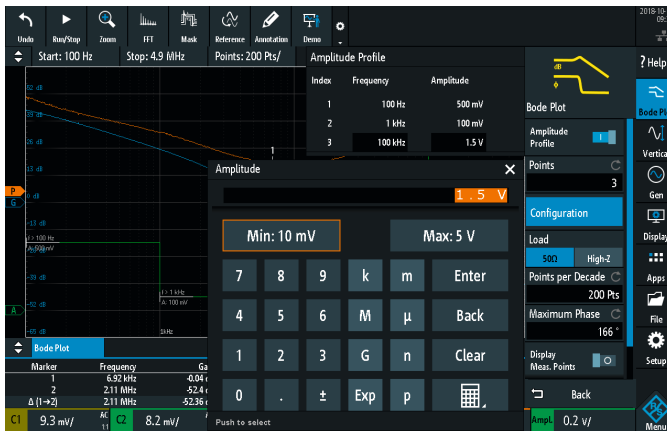
Der Amplitudenausgangspegel des Generatorsignals kann während der Messung variiert werden, um das Rauschen des Prüflings zu unterdrücken
