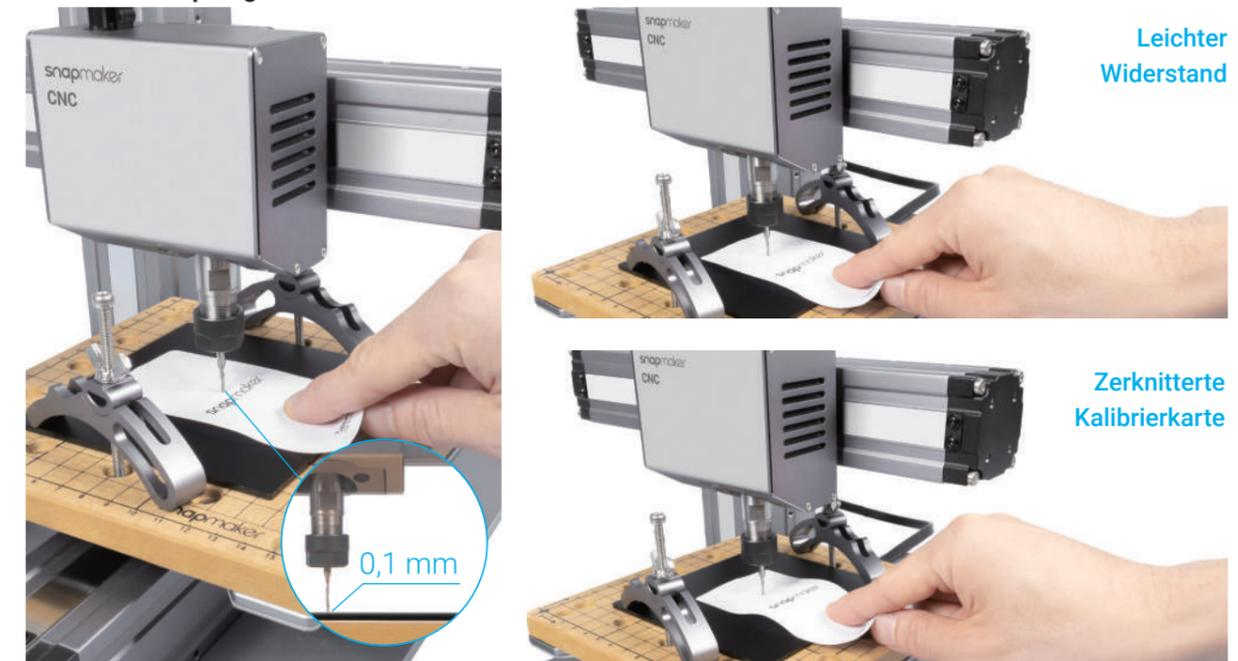
4. Tippen Sie auf **Z+**, um den CNC-Fräser anzuheben, bis er sich über dem Klemmsatz befindet, und tippen Sie dann auf **Ausführungsgrenze**, um zu prüfen, ob der Arbeitsursprung korrekt ist. Wenn ein Teil der vom CNC-Fräser gezogenen Begrenzung außerhalb des Materials liegt oder wenn der CNC-Fräser auf Teile des Gerätes stößt, setzen Sie den Arbeitsursprung zurück und führen Sie die Begrenzung erneut aus.
