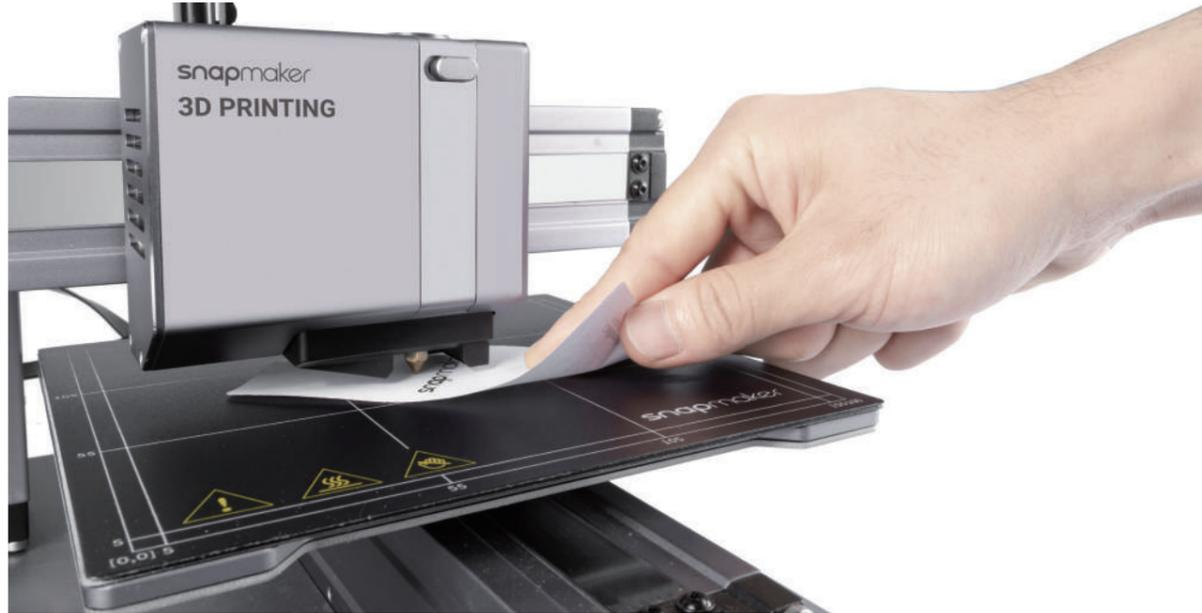
3. Stellen Sie die Höhe der Düse weiterhin anhand der **Auf** und **Nach unten** Tasten, bis Sie einen leichten Widerstand beim Herausziehen der Kalibrierkarte spüren. Die Kalibrierkarte sollte sich zerknittern, wenn Sie sie nach vorne schieben. Tippen Sie auf **Speichern** um die Kalibrierungseinstellungen zu speichern.
