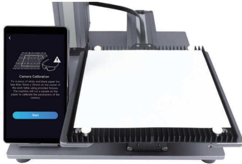
2. Tippen Sie auf **Start**, und das Gerät wird das eingravierte Quadrat zur Kalibrierung der Kamera verwenden.
