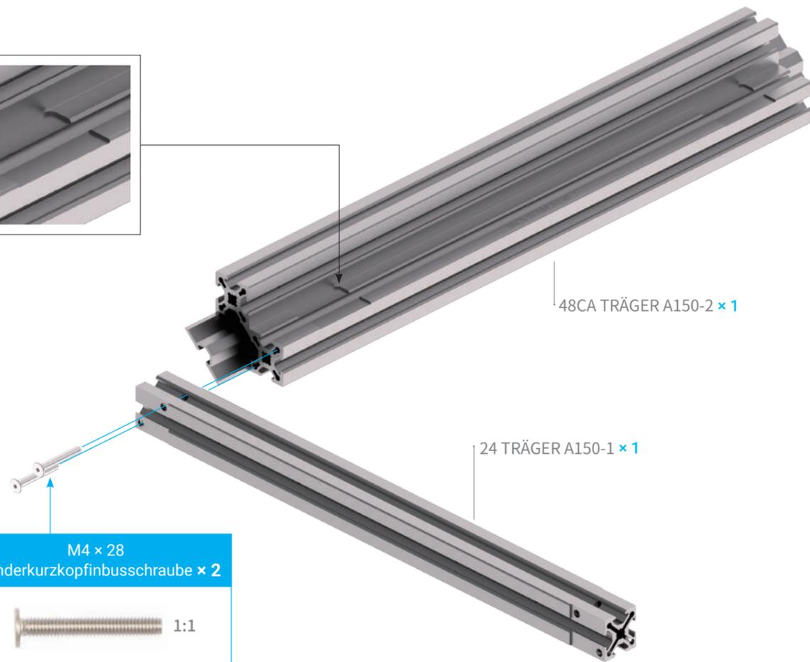
Achten Sie beim Zusammenbau darauf, dass die 48CA Träger genau in die Nuten der 24 Träger montiert werden.
