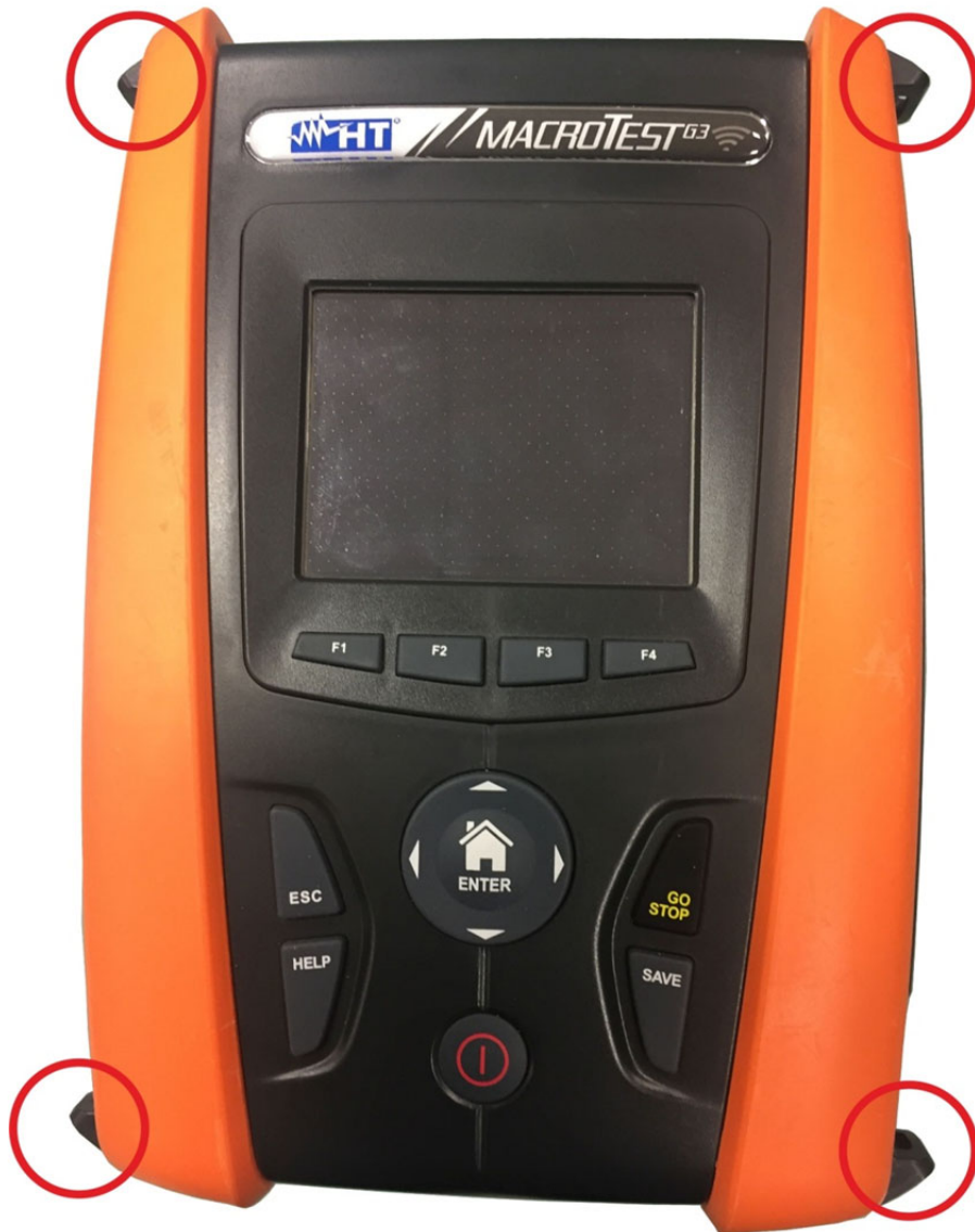
Abb. 42: Messgerät mit den neu angebrachten Gummischutzholstern und Ösen
