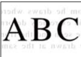
**Beim Scannen dünner Vorlagen werden möglicherweise Bilder auf der Rückseite gescannt.**
