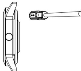
Richten Sie das Magnet-Ladekabel an den Metallkontakten der Smartwatch aus, bis die Ladeanzeige auf dem Display angezeigt wird.
