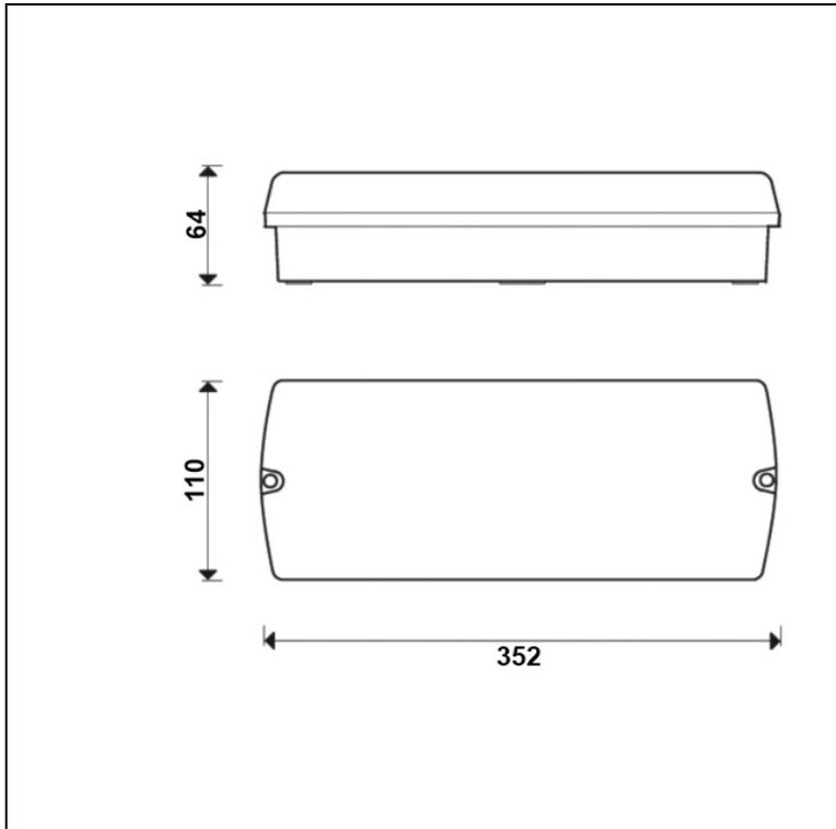
LED-Sicherheits- und Rettungszeichenleuchte in IP 65 Standardausführung, als Einzelbatterie-Notleuchte mit AUTOTEST-Funktion, Signalisierung über 1x mehrfarbige Status-LED, inklusive Prüftaster. Gemäß DIN EN 60598-1, DIN EN 60598-2-22, DIN EN 62034 und DIN EN 1838 für Anlagen gemäß DIN VDE 0108 zum separaten Betrieb.
