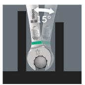
Der Ringmaulschlüssel Joker 6003 seiner besonderen Maulgeometrie – eine um 7,5° geschwenkte Maulseite und die Doppelsechskantgeometrie verdoppelt die Ansetzmöglichkeiten bei wiederholter 180°-Drehung des Schlüssels um die Längsachse. Muttern bzw. Schraubenköpfe alle 15° können "gepackt" werden. Den jeweiligen Ansetzpunkt findet der Joker 6003 nach jedem Wenden sozusagen von selbst.
