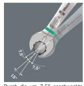
Durch die um 7,5° geschwenkte Maulseite, Doppelsechskantgeometrie eine angepasste Anwendungsweise (Ansetzen – Schrauben – Drehen – erneut Ansetzen - Schrauben - Drehen usw.) können auch Schraubsituationen gelöst werden, die weniger als 30° Schwenkwinkel zulassen.
