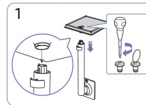
Stellen Sie den Standfuß in der in der Abbildung gezeigten Richtung auf den Standfußanschluss. Drehen Sie die Befestigungsschraube unten am Standfuß bis zum Anschlag, damit er sicher befestigt ist.
