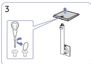
Lösen Sie die Verbindungsschraube auf der Unterseite des Standfußes und entfernen Sie dann die Halterung für den Standfuß von dem Standfußsockel, indem Sie sie wie in der Abbildung gezeigt in Pfeilrichtung ziehen.
