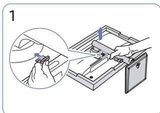
Platzieren Sie das Produkt wie in der Abbildung gezeigt auf einer sauberen und flachen Oberfläche. Drücken Sie die Taste nach oben und halten Sie sie gedrückt. Drehen Sie die Halterung für den Standfuß der Anzeige 10° im Gegenuhrzeigersinn.
