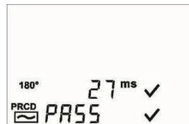
→ In einigen Fällen muss der mobile RCCB/PRCD an einer Steckdose angeschlossen werden (die nicht durch andere RCCBs geschützt ist) – der Test muss wie für fest installierte RCCBs/RCDs durchgeführt werden.
