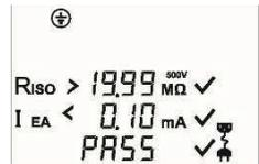
• „PASS“ wird im Display angezeigt, wenn der gesamte Test erfolgreich abgeschlossen wurde.
