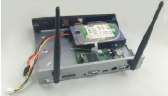
2. Verbinden Sie das SATA Kabel sowie das Spannungskabel mit der Festplatte und dem Mainboard.
