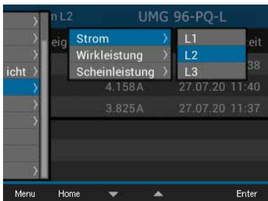
Abb. Schleppzeiger-Anzeige mit den Untermenü-Einträgen Strom, Wirkleistung und Scheinleistung.
