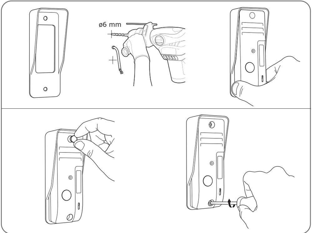
Nach der Verkabelung der Türsprechanlage (siehe Abschnitt Anschlüsse), diese im Regenschutz einsetzen und verschrauben.
