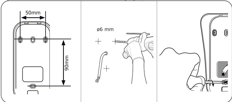
Nach der Verkabelung der Türsprechanlage (siehe Abschnitt Anschlüsse), diese im Regenschutz einsetzen.
