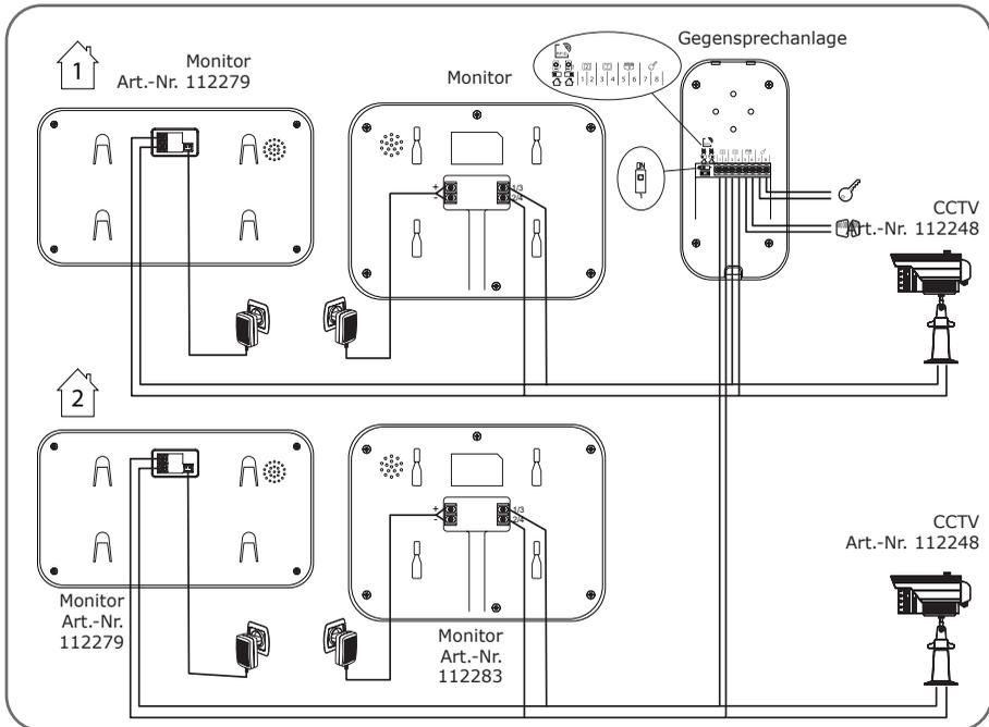
**WICHTIG:** Wenn bei der Öffnung der Tür Probleme auftreten, die zum Beispiel auf die große Entfernung zwischen dem Display und der Türsprechanlage zurückzuführen sind, empfehlen wir eine separate Stromversorgung. Bei Verwendung einer separaten Stromversorgung muss zur Steuerung der Video-Gegensprechanlage wie gezeigt ein Relais 12 V (nicht im Lieferumfang) angeschlossen werden.
