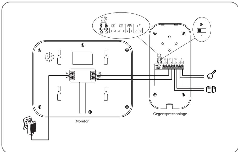
**WICHTIG:** Schließen Sie die Klemmen 5 und 6 direkt an den Öffner-/Schließkontakt der automatischen Steuerung an (drahtgebundener Steuereingang eines Torantriebs).
