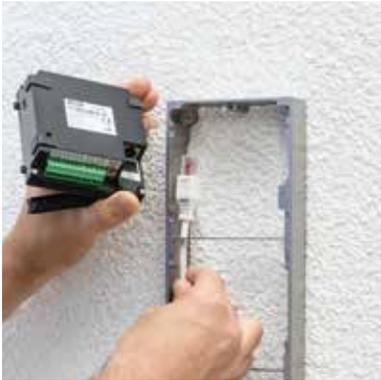
Platzieren Sie den Aufputzrahmen über der Unterputzdose und montieren Sie ihn mit 4 Schrauben in die Wand. Stecken Sie das Netzkabel in das Videomodul und verbinden Sie ggf. weitere Module mit dem Videomodul. Setzen Sie nun die Rahmenblende auf und befestigen Sie diese mit dem beiliegenden Inbusschlüssel.
