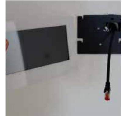
Stecken Sie das Netzkabel in den Monitor. Setzen Sie nun den Monitor auf den Halter und folgen Sie dem Installations-Assistenten auf dem Monitor (siehe nächste Seite).
