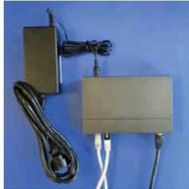
Verbinden Sie die Netzkabel von Videomodul und Monitor mit den Ports am PoE-Switch. Versorgen Sie nun den PoE Switch mit Strom. Verbinden Sie den PoE Switch mit ihrem Router um eine Internetverbindung herzustellen.
