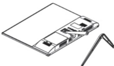
3) Montieren Sie den Standfuß mit der Befestigungsschraube am Ständer.
