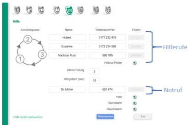
Die **ersten drei Hilfenummern** können wiederholt werden. Sie werden zusätzlich mit **iCM** überwacht, um fehlerhafte Kontakte zu erhalten, z.B. Anrufbeantworter. In seltenen Fällen kann ein IP-Router oder eine IP-Netzbetreiber Töne während des Wählvorganges einspielen, die der iCM als ungültiger Kontakt interpretiert. Schalten Sie in diesem Fall den sogenannten **Hilferuf-Prüfer** ab.
