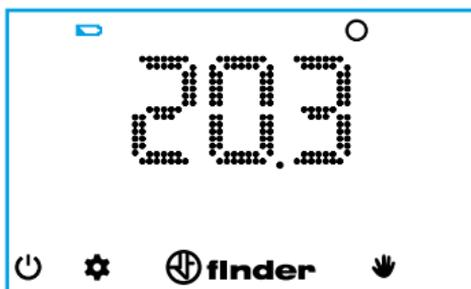
Bei Erreichen des zweiten Schwellwertes, schaltet das Chronothermostat ab. Das Relais im Ausgangskreis schaltet ab und es ist nicht mehr möglich, weitere Einstellungen vorzunehmen. In diesem Zustand blinkt das Batteriesymbol alle 5 Sekunden (bis die Batterien vollständig entladen sind).
