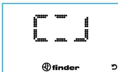
In dem Fall, dass die App-Anmeldeinformationen bis zum Ablauf der vorgegebenen Zeit nicht eingegeben wurden, führt das Chronothermostat einen RESET der Konfiguration durch, und das interne Wi-Fi wird abgeschaltet.
