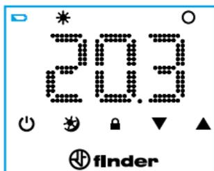
Bei der zweiten Schwelle schaltet das Thermostat ab, das Ausgangsrelais wird auf AUS gesetzt und es ist nicht mehr möglich, weitere Einstellungen vorzunehmen. In diesem Zustand ist das blinkende Batteriesymbol alle 5 Sekunden zu sehen (bis die Batterien vollständig entladen sind).
