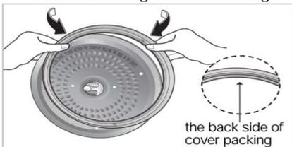
5. Wenn Sie die Gummidichtung an der abnehmbaren Abdeckung befestigen, halten Sie sie über die Abdeckung und ziehen Sie sie kreisförmig über die Kante.
