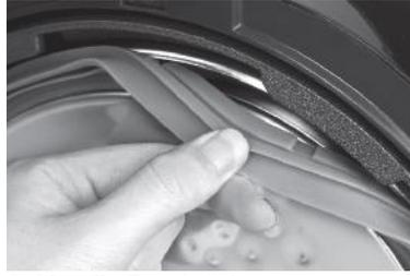
2. Um die Druckdichtung zu entfernen, halten Sie sie wie in der Abbildung gezeigt und ziehen Sie die Dichtung heraus.
