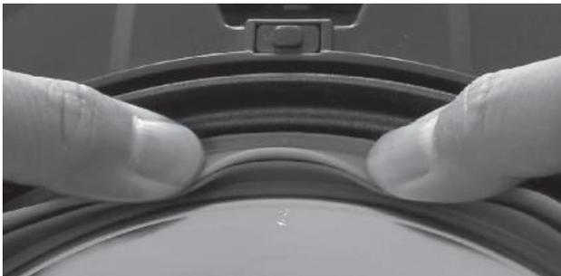
1. Wie in Abbildung 1 dargestellt, setzen Sie die Druckdichtung mit der Standardkerbe Nr.1 am Innendeckel zusammen, bevor Sie auf den äußeren Rand der Dichtung drücken und in die Nut einsetzen. Wiederholen Sie dies mit den Punkten 2 bis 6.
