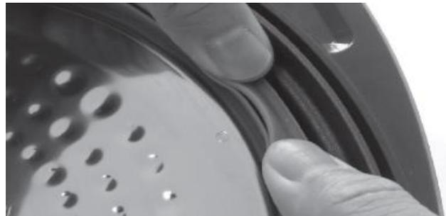
2. Nachdem Sie die Standardpunkte 1 bis 6 erreicht haben, drücken Sie die Dichtung in die Nut, indem Sie auf den äußeren Rand drücken.
