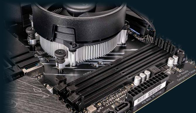
▶ Die Standardkühler für AMD-Prozessoren werden in der Regel direkt auf dem Mainboard verschraubt. Bei Intel-Prozessoren werden stattdessen häufig Stifte verwendet, die lediglich herunter gedrückt werden müssen und automatisch einrasten.
