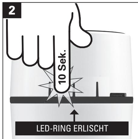
Betätigen Sie **innerhalb von 7 Sekunden die Auswahl Taste** und halten Sie sie **10 Sekunden lang gedrückt**. Als Bestätigung **erlischt** der LED-Lichtring.
