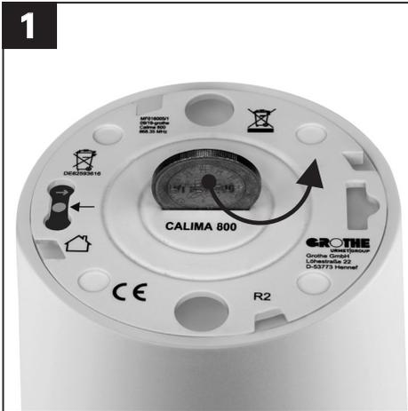
Öffnen Sie das Akkufach, indem Sie den Deckel mit einer **Münze gegen den Uhrzeigersinn** aufdrehen.
