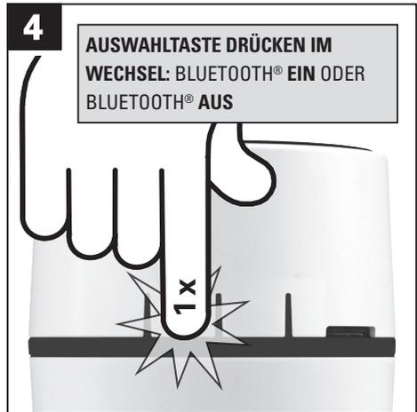
Indem Sie die **Auswahltaste** drücken, wird die **Bluetooth®-Funktion eingeschaltet**. Beim nächsten Drücken der Auswahltaste wird **Bluetooth®** wieder **ausgeschaltet**.
