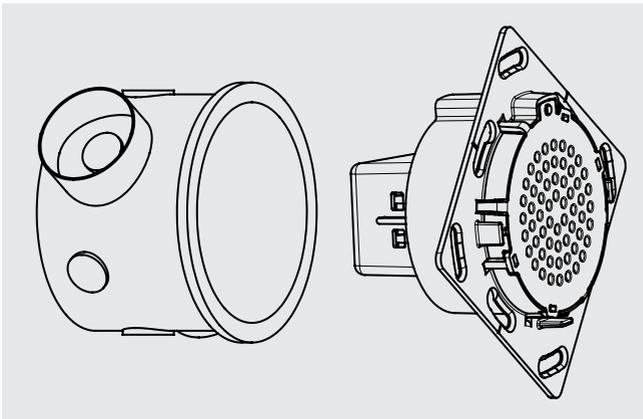
Schrauben Sie den Funkgong mit den Geräteschrauben der UP-Gerätedose an den Schraubdomen fest.
