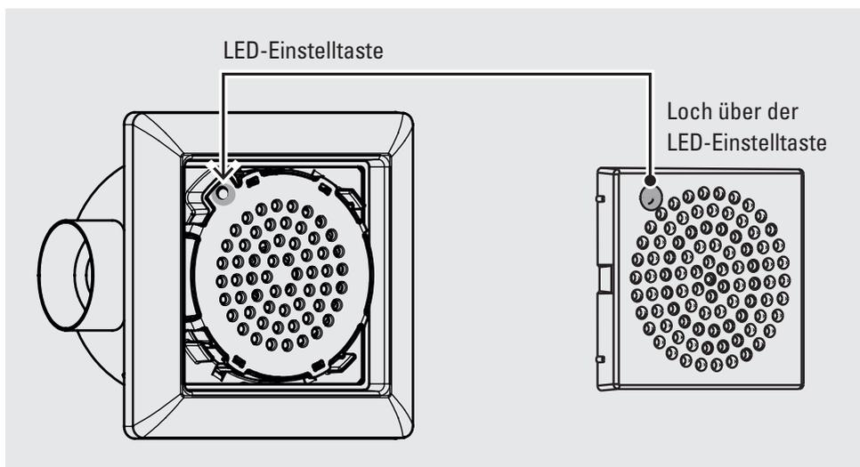
**Wichtig:** Versuchen Sie nicht, die Abdeckung gewaltsam aufzusetzen, sondern kontrollieren Sie die korrekte Position, falls sich die Abdeckung nicht bündig in den Rahmen setzen lässt (da die Abdeckung nur in einer Position auf den Funkgong passt).
