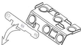
Entfernen Sie den Schutz um die Klemme des Zusatzmoduls
