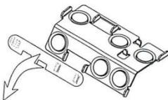
Entfernen Sie den Schutz um die Klemme des Zusatzmoduls
