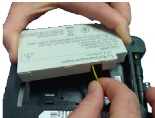
Abbildung 4:Einführen des Anschlussdrahts in das Akkugehäuse
