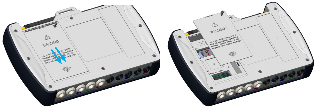
Abbildung 2: Entfernen der Akkuabdeckung
