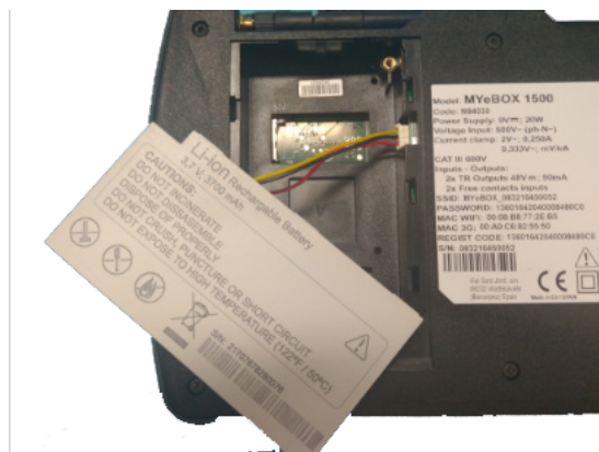
Abbildung 3:Anschließen des Akkus
