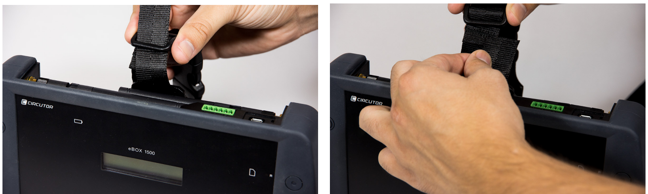
Abbildung 8: Anbringen des Trageriemens: Schritte 3 und 4
