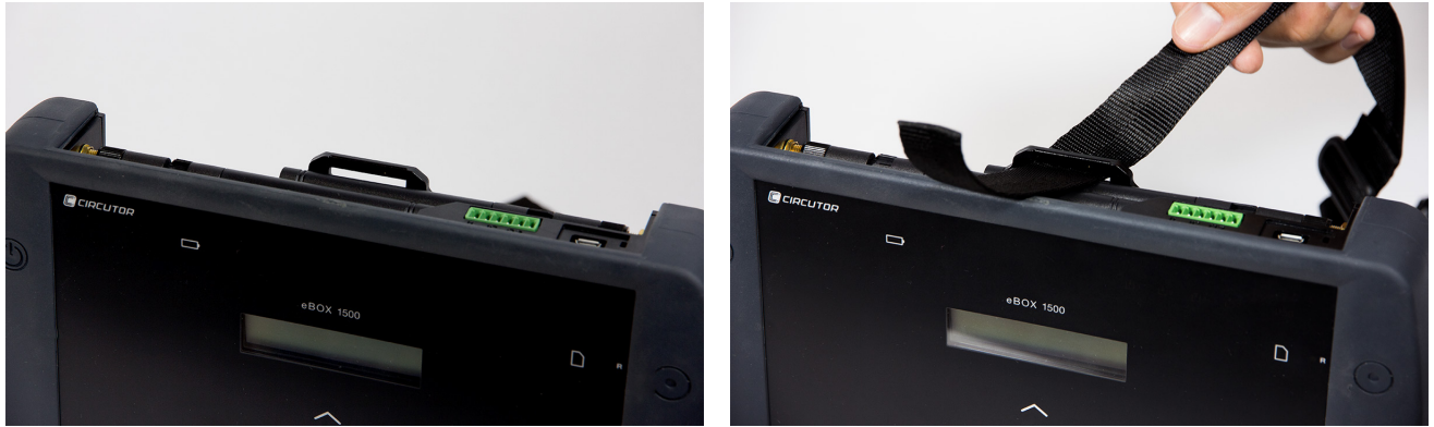
Abbildung 7: Anbringen des Trageriemens: Schritte 1 und 2
