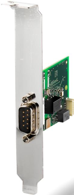
Das Ixxat USB-to-CAN V2 embedded mit galvanischer Trennung wird über eine Platine und ein internes USB-Kabel an einen PC angeschlossen. Es stellt eine unkomplizierte und kostengünstige Möglichkeit dar, einen Computer mit internem USB-Anschluss an ein CAN-Bus-Netzwerk anzuschließen und kann z.B. im Bereich von Test-, Entwicklungs-, Wartungs- oder Steuerungsanwendungen eingesetzt werden.
