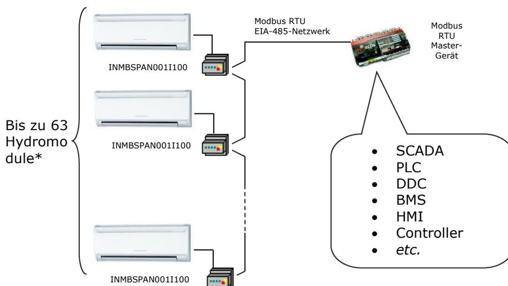
\* Bis zu 63 Intesis-Geräte können in demselben Modbus RTU-Bus installiert werden. Je nach konfigurierter Geschwindigkeit kann jedoch die Installation von Modbus-Wiederholern erforderlich sein
