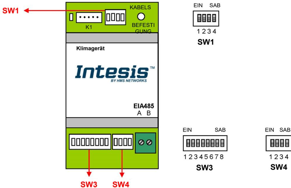
Die folgenden Tabellen gelten für die Konfiguration der Schnittstelle durch DIP-Switches:
