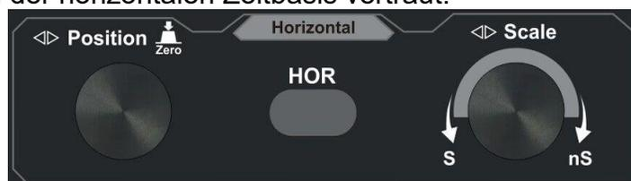
Abb. 3-11 Bedienelemente für Horizontalsteuerung
