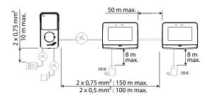
Mit Spannungsversorgung auf DIN-Hutschiene:
