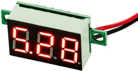
Dieses extrem kompakte Mini-Voltmessgerät für einen Spannungsbereich von 3 -30 Volt hat eine 3-Ziffern 7-Segment-Anzeige (0,36-Zoll). Der Messwert wird auf eine oder 2 Nachkommastellen genau angezeigt und alle 0,3 Sekunden aktualisiert. Der minimale Stromverbrauch von unter 30 mA zeichnet seine Leistung aus. Es verfügt über 2 Befestigungsösen.
