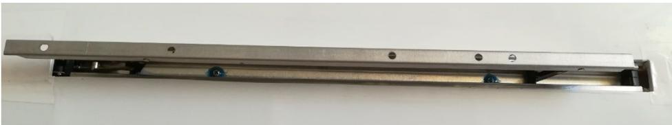
**7. Arbeitsschritt:** Fertigen und befestigen der Klappenabdeckung. Die Abdeckung aus 2 mm Balsabrett fertigen (Größe ca. 262 x 13,8 mm), am Ausschnitt und in der Dicke anpassen und abschließend mit Oracover bebügeln. Verklebt wird die Abdeckung mit dem beweglichen Bügel der Klappe mittels doppelseitigem Klebeband (Breite 5 mm) und wird zusätzlich mit einem Tropfen 2-Komponentenkleber an den Bügelenden (siehe rote Kreismarkierung) gesichert.
