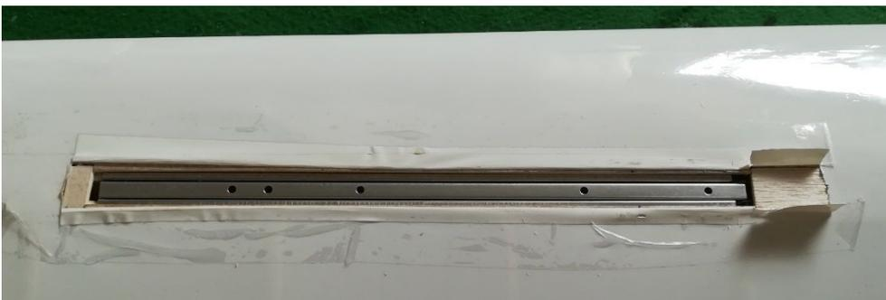
**5. Arbeitsschritt:** Bügeln mit Oracoverfolie. Die aufgeschlitzte Folie zurückklappen und erneut auf der Balsabeplankung aufbügeln und dabei die Innenkanten abdecken. Die beidseitig des Schlitzes mit Balsabrettchen geschlossene Beplankung mit jeweils einem quadratischen Stück Bügelfolie überdecken. Hierbei ebenfalls die Innenkante abdecken.
