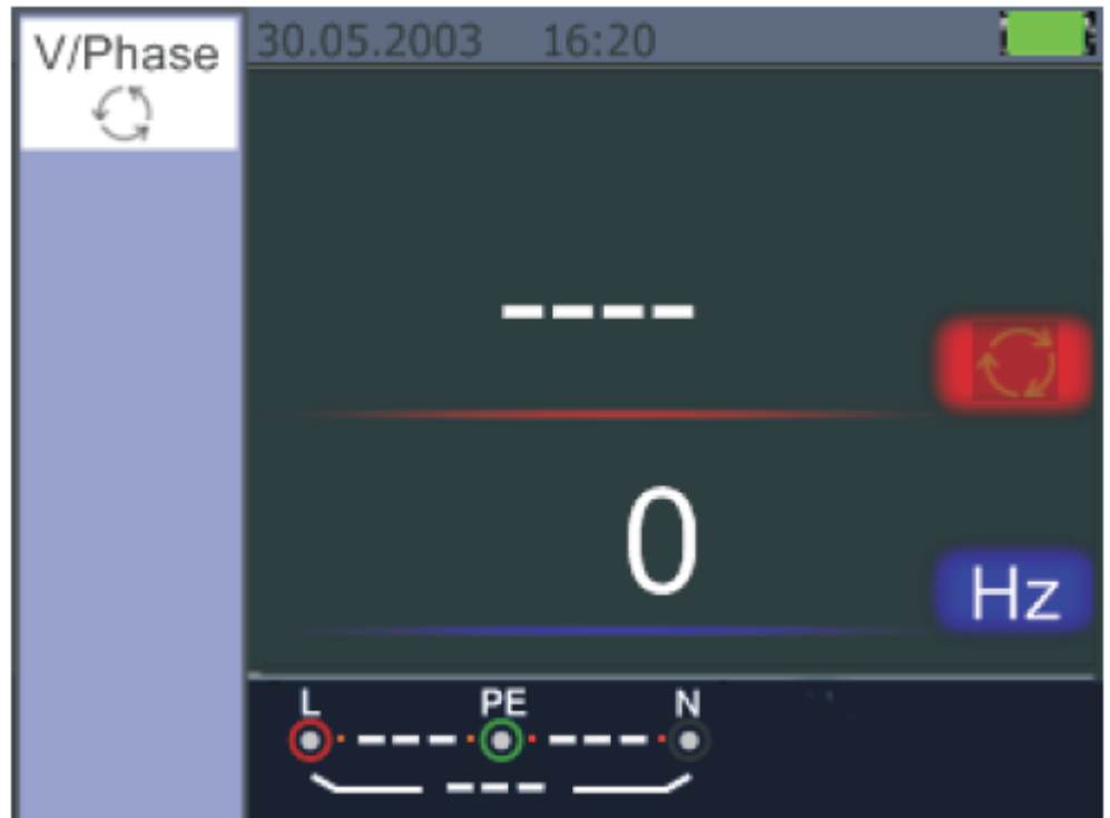
Abb. 5.2.8.1 Das Anfangsbild der Phasensequenzmessung
