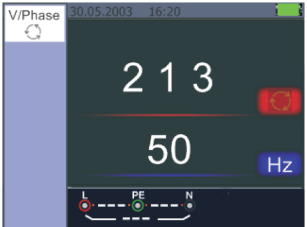
Abb. 5.2.8.4 Phasensequenz wenn gegen den Uhrzeigersinn verbunden.
