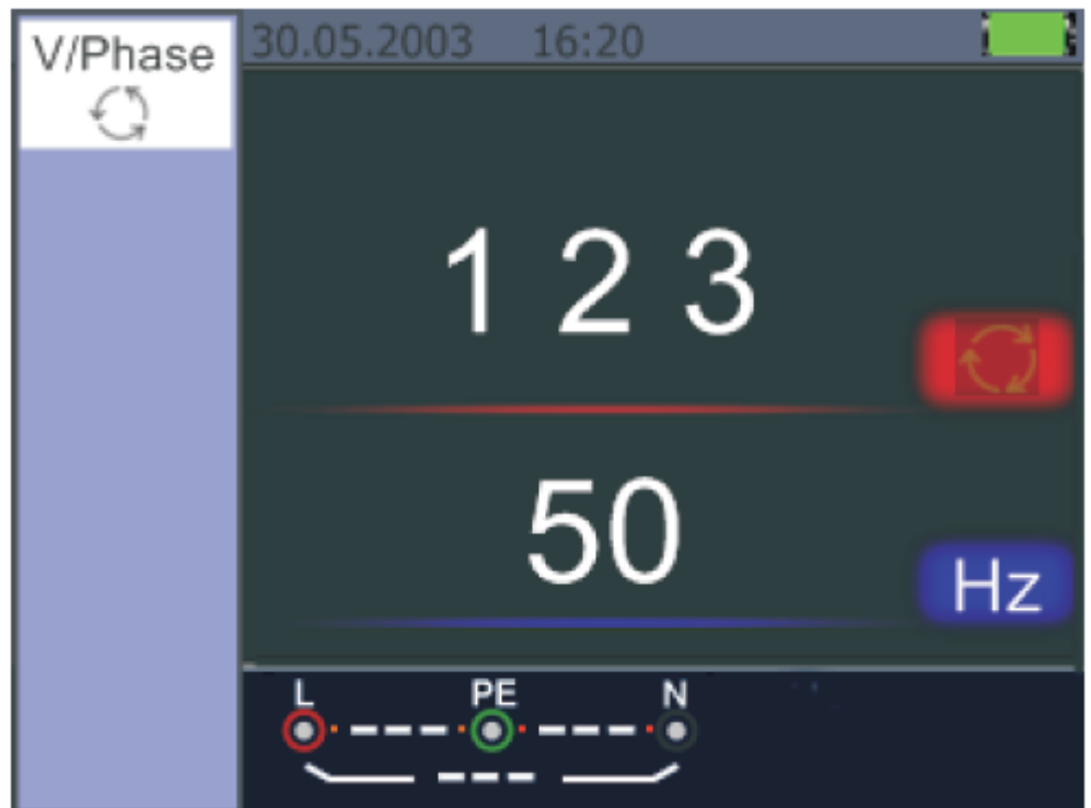
Abb. 5.2.8.3 Phasensequenzbildschirm wenn im Uhrzeigersinn verbunden.
