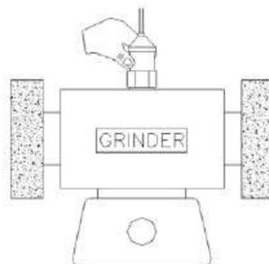
Besteht die Oberfläche des zu messenden Objekts aus Eisen, verbinden Sie den Sensor mit dem Magnetadapter. Setzen Sie nun, wie im Bild beschrieben, den Sensor mit dem Magnetadapter auf das Messobjekt.
