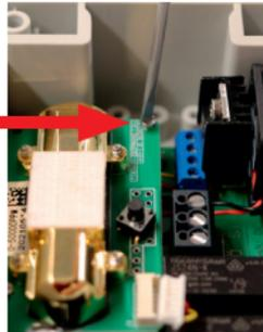
Modul, die sich in den gegenüberliegenden Ecken befinden. Die Schrauben sind sehr klein (M2) und können leicht verloren gehen. Das Sensor-Modul ist nun vom Hauptgerät getrennt und Sie können es heraus nehmen. Nehmen Sie nun das USB-Kalibrier-Adapterkabel und verbinden es mit dem Sensor-Modul.
