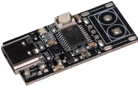
Mit diesem kleinem Modul können Sie USB-PD Protokolle auslösen und somit zum Beispiel Ihren Laptop über ein PD-fähiges USB-C Netzteil laden. Die Ausgangsspannung ist über den auf dem Modul integrierten Knopf in 5 Stufen (5 V, 9 V, 12 V, 15 V und 20 V) einstellbar. Die momentan ausgewählte Spannung kann an der Farbe der auf dem Modul integrierten RGB-LED abgelesen werden. Das Modul ist aufgrund seiner Ausgangsschnittstellen flexibel einsetzbar und leicht zu integrieren.
