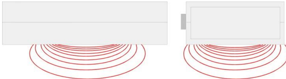
Seitenansicht: Messfeld und Eindringtiefe ca. 25 mm
