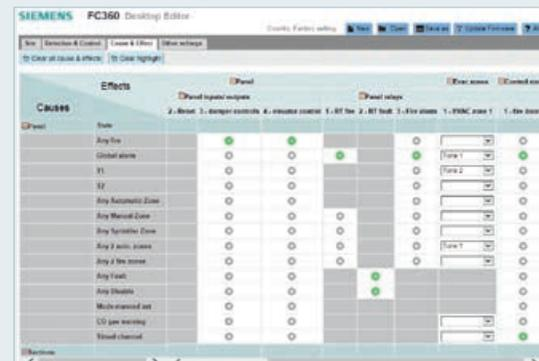
Die meisten Systeme benötigen alle Alarmierungsgeräte und Steuerausgänge, um bei einem Brand zu funktionieren. Diese Operation ist standardmäßig verfügbar. Wenn komplexere Steuerungen erforderlich sind, macht die einzigartige Ursache-Wirkungs-Matrix des FC360 alle erforderlichen Änderungen einfach und logisch.
