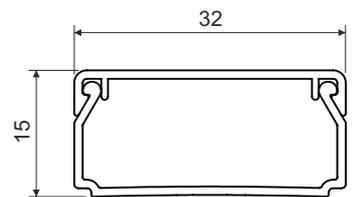
Produktbeschreibung: geeignet zur Verlegung von Niederspannungsleitungen
