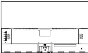
2. Setzen Sie die Halterung des Standfußes wie abgebildet in das Monitorgehäuse ein.
