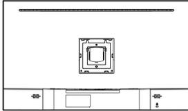
2. Befestigen Sie die Halterung des Standfußes mit 2 Schrauben am Monitorgehäuse.
