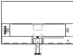
3. Legen Sie die Basis des Ständers auf eine waagerechte Plattform, setzen Sie sie in den Kartenschlitz ein und drehen Sie sie in die auf dem Bild unten angegebene Richtung. Nach der Installation ist ein "Pop"-Geräusch zu hören.
