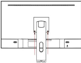
3. Stellen Sie den Ständerfuß auf eine horizontale Plattform, stecken Sie ihn in den Kartenschlitz und drehen Sie ihn in die Richtung wie auf dem Bild unten gezeigt. Nach der Installation ist ein "Pop"-Geräusch zu hören.
