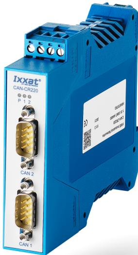
Der CAN-CR220 Repeater mit zwei CAN Kanälen dient zur galvanischen Trennung zweier Segmente eines CAN Netzwerks und bietet eine sehr hohe galvanische Isolation von 4 kV, womit er sich auch für den Einsatz in medizinischen Anwendungen eignet. Er kann zur Erhöhung der Belastbarkeit des CAN Busses mit Knoten, zur physikalischen Kopplung von CAN Bussystemen oder zum Einfügen einer galvanischen Trennung eingesetzt werden.
