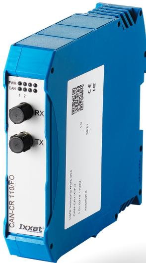
Der CAN-CR110/FO Repeater mit zwei CAN/CAN FD Kanälen (davon eine als LWL-Schnittstelle) dient der Umsetzung des CAN Signals von Kupferdraht (ISO 11898-2) auf Lichtwellenleiter. Er kann zur Erhöhung der Belastbarkeit des CAN Busses mit Knoten, zur physikalischen Kopplung von CAN/CAN FD Bussystemen oder zum Einfügen einer galvanischen Trennung eingesetzt werden.
