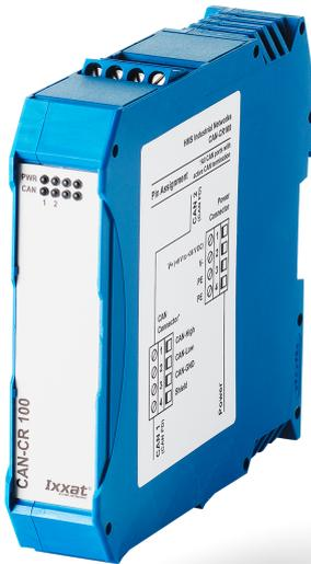
Der CAN-Repeater CAN-CR100 mit integrierten Busabschlusswiderständen und zwei CAN/CAN-FD-Schnittstellen kann zur Verbesserung der Belastbarkeit des CAN-Busses mit Knoten, zur physikalischen Kopplung von CAN/CAN FD-Bussystemen oder zum Einfügen einer galvanischen Trennung eingesetzt werden.
