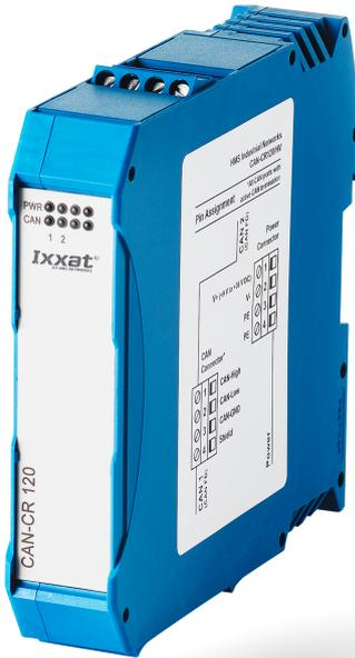
Der CAN Repeater CAN-CR120/HV mit integrierten Busabschlusswiderständen und zwei CAN/CAN FD Schnittstellen kann zur Verbesserung der Belastbarkeit des CAN Busses mit Knoten, zur physikalischen Kopplung von CAN/CAN FD Bussystemen oder zum Einfügen einer galvanischen Trennung bis zu 3 kV für einen höheren Schutz der CAN Segmente eingesetzt werden.
