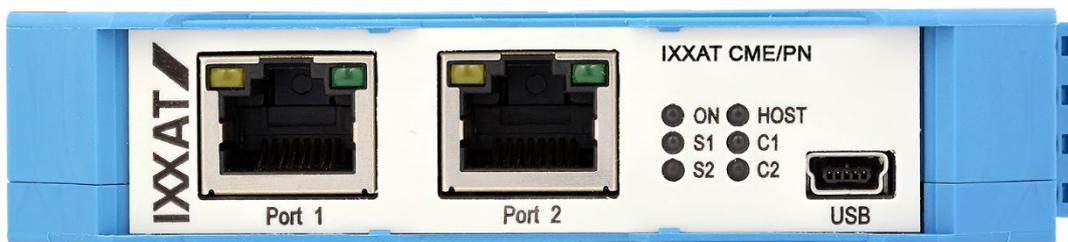
**Bild 3-4: Anzeigen des Ixxat CME/PN**
