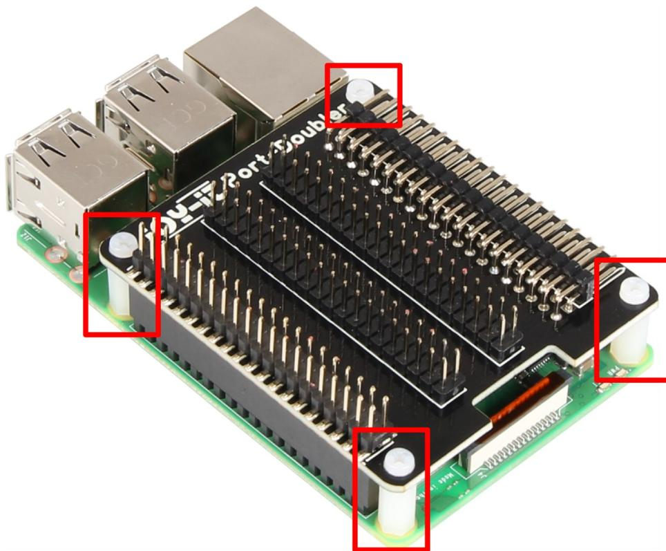
Stecken Sie den Port-Doubler einfach, wie im Bild zu sehen, auf Ihren Raspberry Pi auf. Verwenden Sie zusätzlich die markierten Abstandshalter, und schrauben Sie diese fest, um die maximale Stabilität zu gewährleisten.
