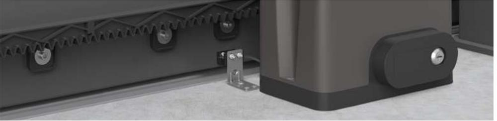
Schließen Sie das Tor. Befestigen Sie den passiven Magneten am Tor. Installieren Sie die Befestigung des Magneten am Boden und achten Sie darauf, dass ein Abstand von max. 13 mm zwischen den Magneten besteht. Die Magneten dürfen sich nicht berühren.
