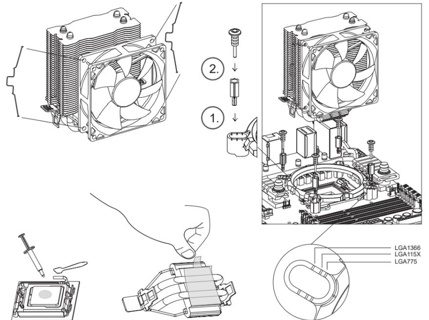
1. Montieren Sie den 92-mm-Lüfter (A.), indem Sie das Lüfterhaltungsset (D.) in die Lüfterbefestigungslöcher einsetzen und in den Nuten des Kühlkörpers befestigen (B.).
